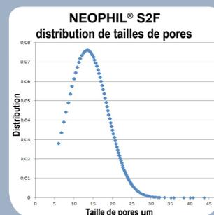
La stabilité de la structure poreuse assure le maintien des performances et donc un taux de rétention des virus constant:
