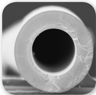
Les avantages du PVDF, un matériau qui remplace les matériaux sulfonés depuis 2010 et est utilisé dans environ 70% des usines à membranes pour le traitement de l'eau dans le monde, sont complétés par de nouvelles performances uniques.
